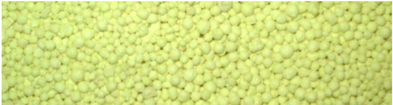
Das Schwefelgranulat im ADN-Filter dient als Aufwuchskörper und als „Futter“ für spezialisierte Bakterien. Foto: AquaCare
