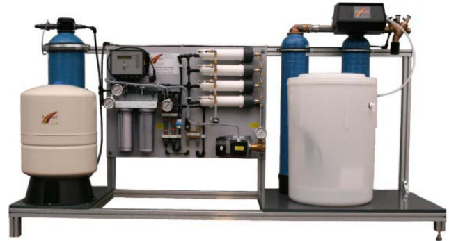
Umkehrosмосeanlage HP2000 mit Drucktank, vorgeschalteter Enthärtung und nachgeschaltetem Vollentsalzer
