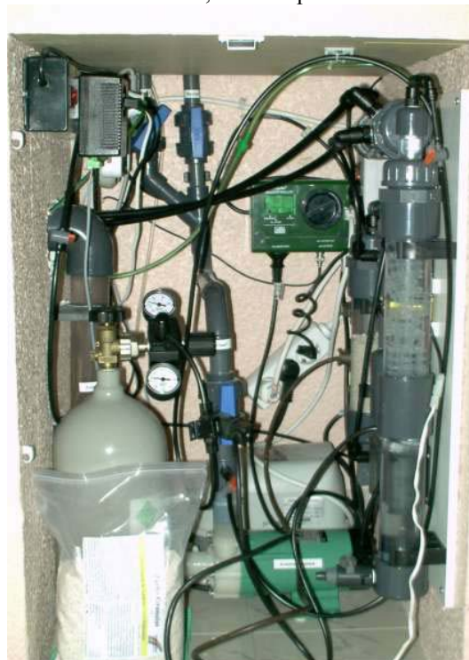
Filtersystem Basic 750 aus PE mit optional eingebautem Abschäumer ACF6000, Turbo -Kalkreaktor Größe 4, Aktivkohlefilter AK100-060, Denitrifikationsfilter ADN110-060, Phosphatfilter PMR110-060, Heizstab 750 W, 2 x Pumpe MX400
