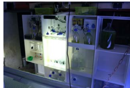
Professionelle Algenaufzuchtanlage mit mehreren Algenröhren, Algenreaktor und die dazugehörige Infrastruktur. Foto: AquaCare
