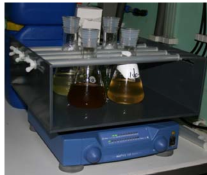
Stammkulturen unterschiedlicher Algen; hier in Erlenmeyerkolben mit Sterilstöpfen auf einem Schüttler. Foto: AquaCare
