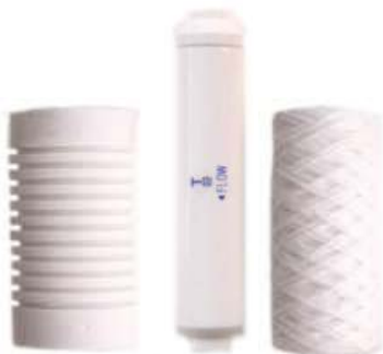
Feinfiltration kann mit Einwegfiltern (Mitte) oder Filtereinsätze durchgeführt werden (links gepresste Polypropylenfasern, rechts: gewickeltes Polypropylengarn)
