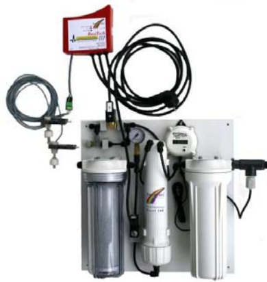
Umkehrosmoseanlage mit RO-Steuerung (automatisches Nachfüllen und Spülfunktion), Reinstwasserfilter und Reinstwassermessgerät
