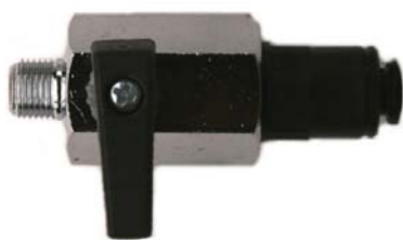
Minikugelhahn mit eingebauter Blende: im geschlossenen Zustand fließt Wasser durch die Blende, im offenen fließt viel Wasser zum Spülen.
