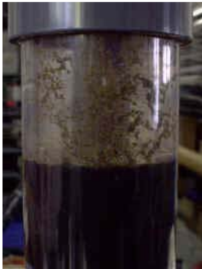
Das Flotat eines Abschäumers sollte eine dunkle Farbe aufweisen. Somit ist eine hohe Anreicherung der Abfallstoffe gewährleistet. Foto: AquaCare
