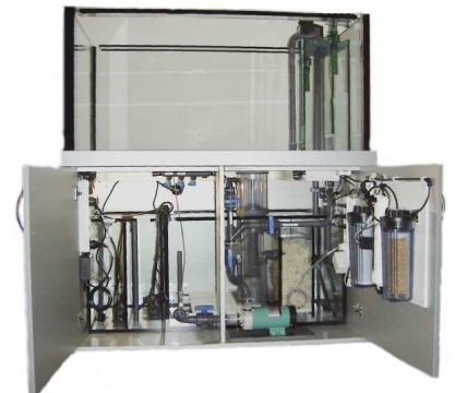
Die gesamte Filtertechnik kann übersichtlich und leicht handhabbar im Unterschrank untergebracht werden.
