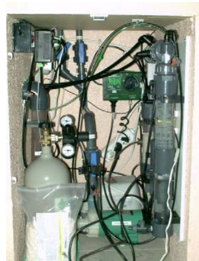
Filtersystem Basic 750 aus PE mit angebautem Abschäumer ACF6000V (Option) und eingebautem Fließbettfilter FBR 110-130 (Option)
