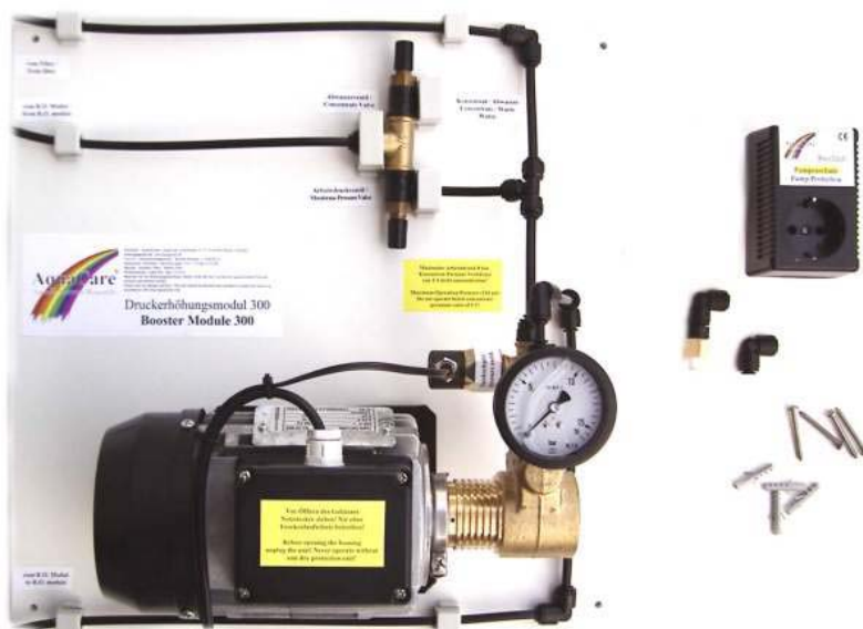
Druckerhöhungsmodul bestehend aus: Drehschieber-Druckpumpe, glyceringefülltes Manometer, Trockenlaufschutz, Konzentratrückführung und Montagematerial. Alle Komponenten sind auf einer Montageplatte befestigt.
