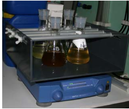
Stammkulturen unterschiedlicher Algen; hier in Erlenmeyerkolben mit Sterilstopfen auf einem Schüttler. Foto: AquaCare
