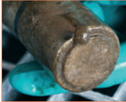
Sensor ohne Ultraschall-Reinhaltung Nach 16 Tagen
