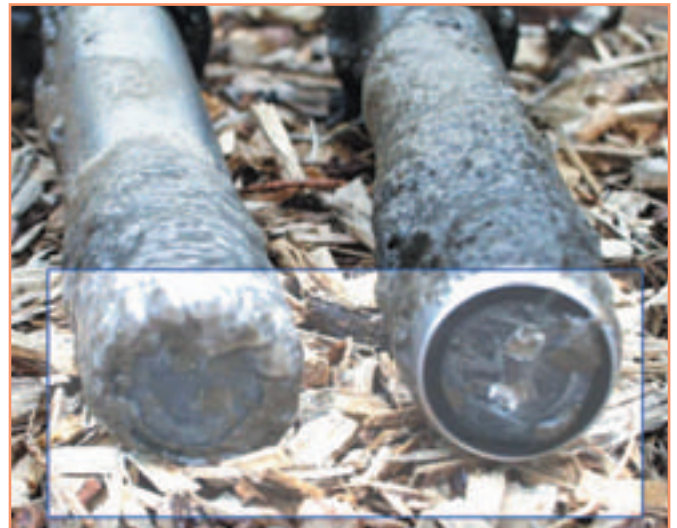
Sensor ohne bzw. mit Ultraschall-Reinhaltungssystem nach 30 Tagen
