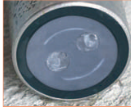
Sensor mit Ultraschall-Reinhaltungssystem Nach 16 Tagen
