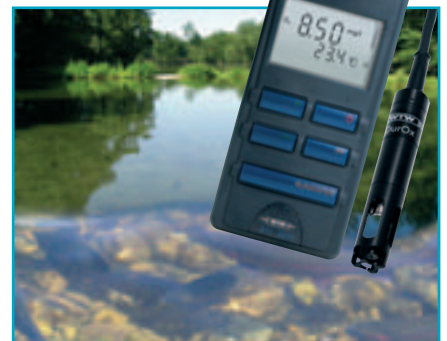
Sauerstoffmessung mit Oxi 315i und DurOx® mit Verbissschutz in der Fischzucht
