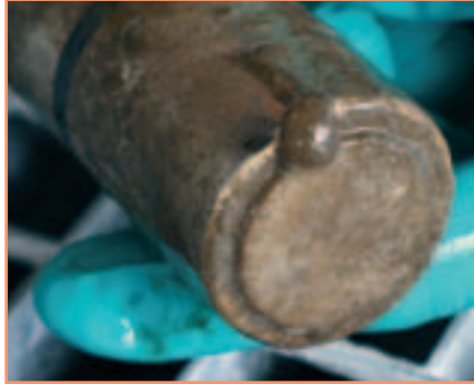
Sonda sin sistema de mantenimiento de limpieza por ultrasonido Después de 16 días
