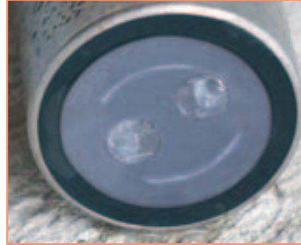
Sonda con sistema de limpieza por ultrasonido Después de 16 días
