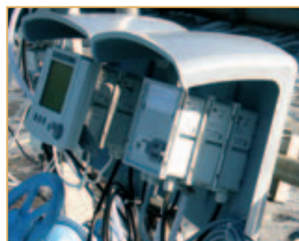
IQ SENSOR NET bajo el techo protector SSH/IQ
