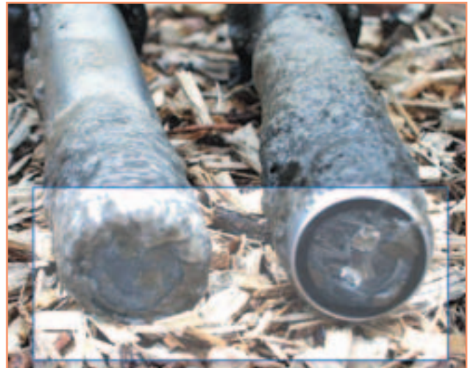
Sonda con y sin sistema de autolimpieza por ultrasonido después de 30 días
