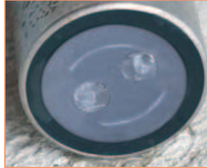
Sensor mit Ultraschall-Reinigungssystem Nach 16 Tagen
