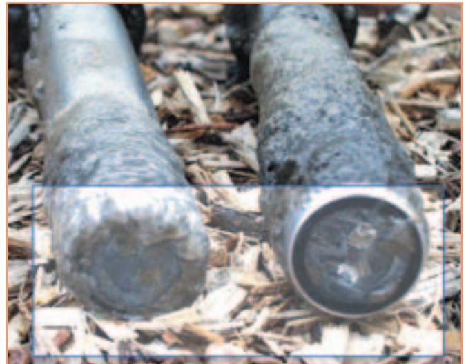
Sensor ohne bzw. mit Ultraschall-Reinhaltungssystem nach 30 Tagen
