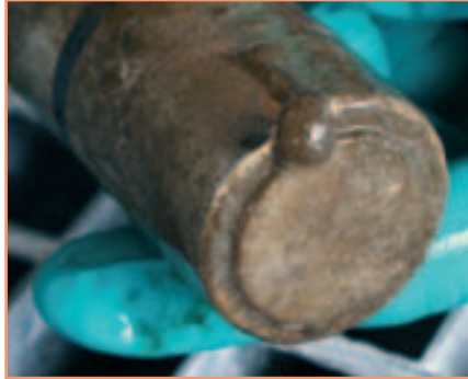
Sensor ohne Ultraschall-Reinigung Nach 16 Tagen
